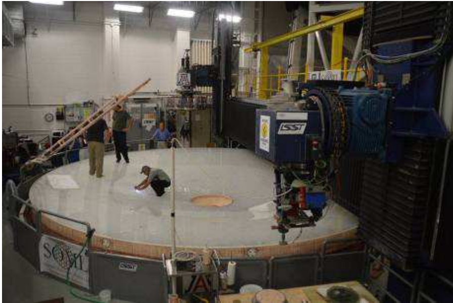
Figura 4.9 – Espelho primário do LSST na fábrica em Tucson, Arizona.
