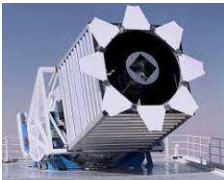
Figura 4.3 - Telescópio de 2.5 metros dedicado aos levantamentos do projeto SDSS (painel esquerdo) e cartucho com as fibras ópticas (painel direito), já colocadas nas posições dos objetos a serem observados, que é montado no foco do telescópio.
