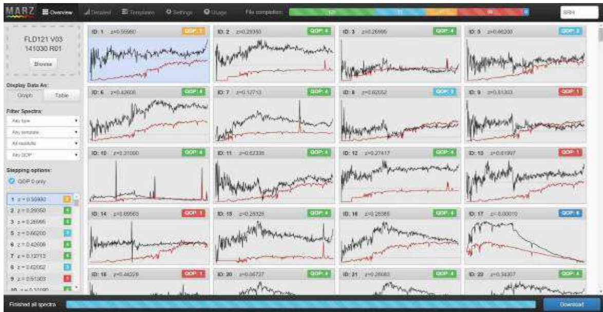
Figura 7.2 - Captura de tela do software MARZ mostrando o espectro observado (preto) e o melhor template usado para uma estimativa do redshift do objeto considerado. A ferramenta permite ao usuário verificar o redshift vindo de um pipeline automático e atribuir o grau de confiança na medida. Esta interface está prevista de ser integrada ao portal a pedido da colaboração OzDES.
