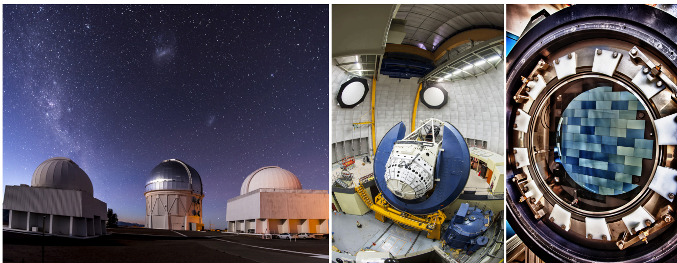
Figura 3: Esquerda: Observatório Interamericano de Cerro Tololo (CTIO) nos Andes chilenos. Centro: Telescópio Victor M. Blanco, com espelho de 4m de diâmetro. Ele está localizado dentro da cúpula prateada do edifício central retratado à esquerda. À direita: Plano focal da DECam (Dark Energy Camera). Ela contém 62 sensores CCD ultrasensíveis especialmente projetados para o projeto DES e permite imagens do universo com profundidade sem precedentes. Crédito da imagem: DOE/FNAL/DECam/R. Hahn/CTIO/NOIRLab/NSF/AURA. Disponíveis publicamente em https://noirlab.edu/public/es/images/ .
